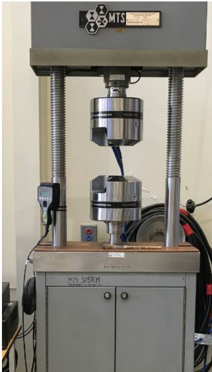
Fig. 5-0-1: MTS Load Frame
